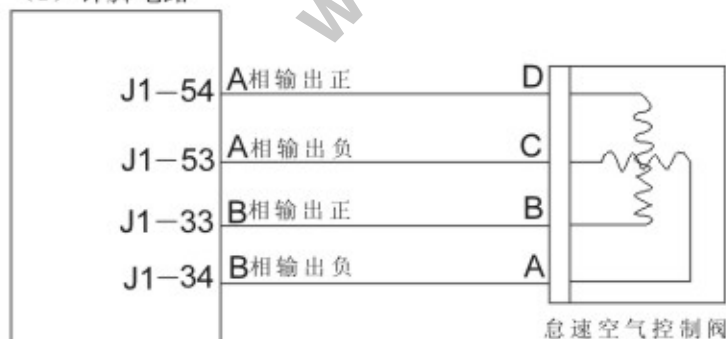
图2-1-38 怠速执行器步进电机电路图
